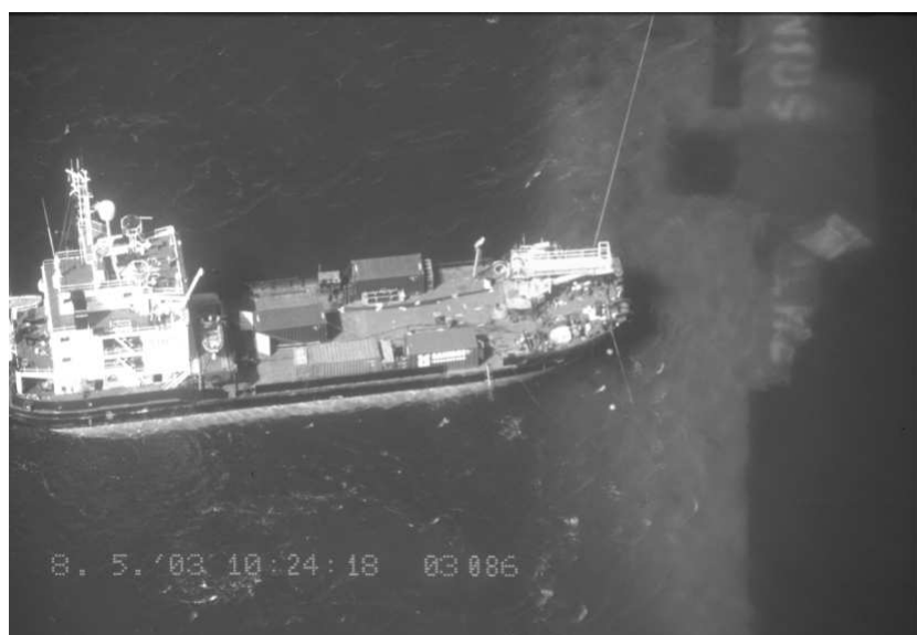
The multipurpose offshore salvage and diving support vessel Union beaver is specially equipped to clean up oil from the sea. Het multifunctionele offshore bergingsvaartuig Union beaver is speciaal uitgerust om olie van het zeeoppervlak op te ruimen (photo MUMM).
