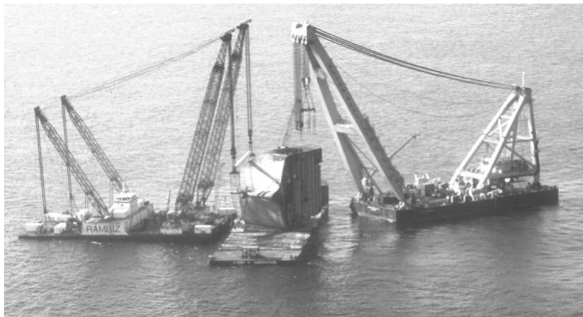
The giant sheerlegs (floating cranes) Asian Hercules II and Rambiz have lifted the first section of the Tricolor and placed it on the floating pontoon Giant 4. De drijvende kranen Asian Hercules II en Rambiz hebben het eerste deel van de Tricolor opgetild en op de drijvende Giant 4 geplaatst (photo MUMM).
